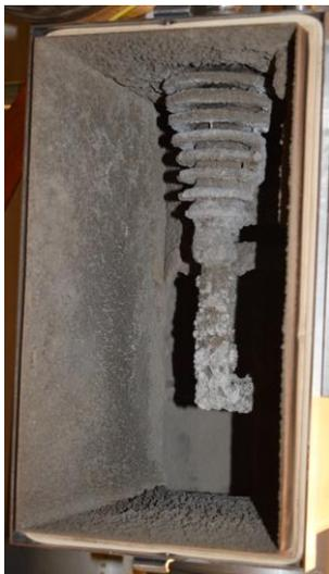
Abscheider im Bereich der Elektrode
