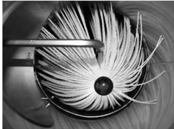
Je nach Verschmutzungsgrad müssen alle 2-4 Jahre das Verlängerungsrohr und der Isolator gereinigt werden (siehe Punkt „Periodische Reinigung“).
